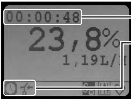
Tiempo restante antes de la detención por falta de nivel en el tanque. Configurable por parametros.
