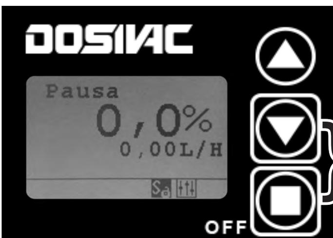
Si se desea interrumpir la dosificación, al entrar en "Función pausa" la bomba quedara en stand by sin dosificar. Para ingresar a este modo se debe presionar simultáneamente las teclas [▼] [■] y la bomba se detendrá hasta que el operador lo desee.
