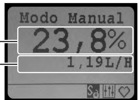
En este modo la bomba no responde a ninguna señal externa. El caudal es ingresado desde el teclado en porcentaje del máximo de la bomba. Luego de varios segundos que se mantiene
